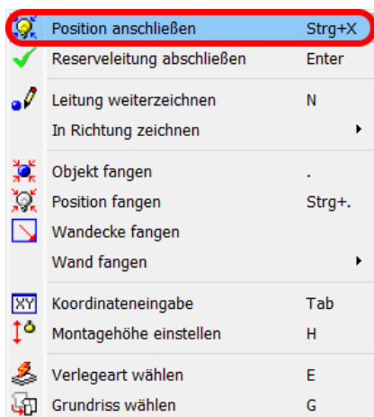
Abbildung 2.4.27: Kontextmenü zum Anschluss der Leitung an den Schalter
