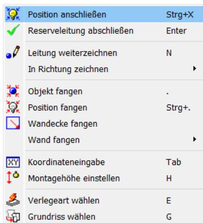
Abbildung 5.12.22: Kontextmenü Position anschließen
