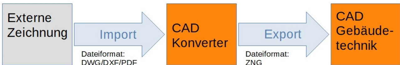
Abbildung 4.1: Schematische Darstellung des Konvertierungsablaufs von DWG/DXF/PDF-Dateien in die Gebäudetechnik
