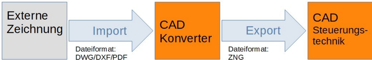
Abbildung 5.1: Schematische Darstellung des Konvertierungsablaufs von DWG/DXF/PDF-Dateien in die Steuerungstechnik
